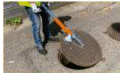
Uso 3: apertura con palanca frontal extendida
